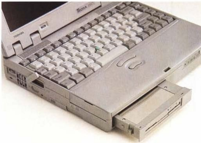
L'unità floppy disk, all'occorrenza, può essere sostituita da un lettore CD-ROM. Hard disk removibile e batteria ricaricabile accessibili dal fondo.
